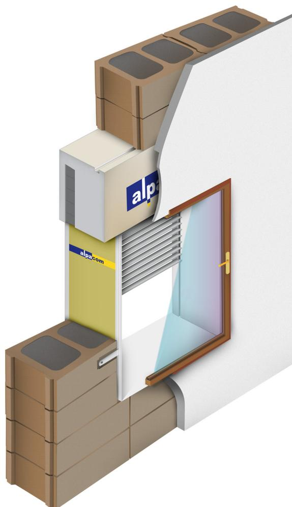
**1)** Spalle laterali prefabbricate coibentate composte da due pannelli: uno in polipropilene da 4 mm di tamponamento l'altro in FIBROCEMENTO, materiale silicocalcareo rinforzato con fibre mineralizzate di cellulosa. Tale pannello è ininfiammabile e imputrescibile, non è attaccabile da roditori insetti e funghi. Il tutto viene legato tramite schiumatura in poliuretano (no C.F.C.)
