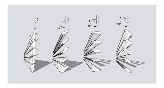
Avvolgibile orientabile di profili tubolari, realizzato in lega di alluminio di elevate caratteristiche, rifinita e protetta con vernici di alta qualità, applicate e termoindurite in un processo continuo.
